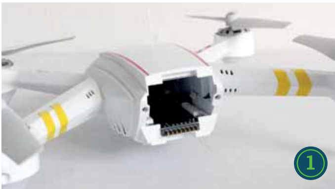
Am Heck des Hornet S befindet sich der große Akkuschaft (1). Der Systemakku passt saugend hinein und lässt sich dort arretieren (2)
