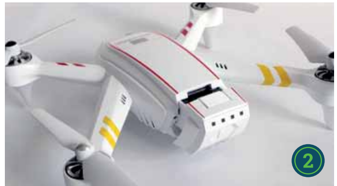
Am Heck des Hornet S befindet sich der große Akkuschaft (1). Der Systemakku passt saugend hinein und lässt sich dort arretieren (2)
