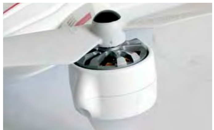
Vier 2204er-Brushlessmotoren treiben den Hornet S an. Im Betrieb an einem 3s-LiPo stellen diese ausreichend Power zur Verfügung
